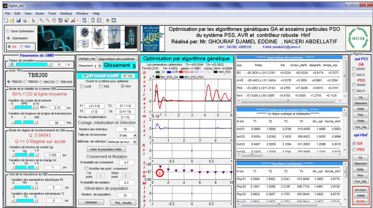
Figure VI.31: synthèses de la commande robuste H ∞ par GA sous GUI-MATLAB
