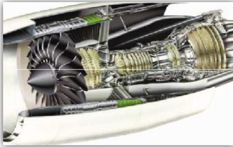
Figure I. 7 : turbo réacteur GE90 [20]
