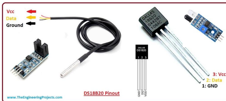
Fig. IV.1 : Les types de DS18B20 et de LM393
