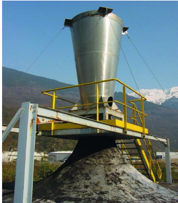
Fig.I.12 Tour à tornades artificielles, vortex
