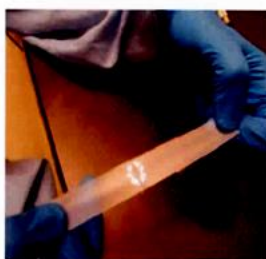
Figure 1.10: Exfoliation répétée du graphite
