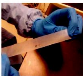
Figure 1.9 : Première Transfert sur exfoliation du graphite
