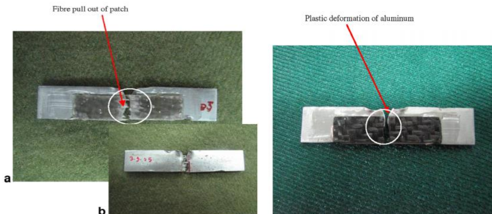
Figure I.25 : Échantillon après essai d'impact [21].
