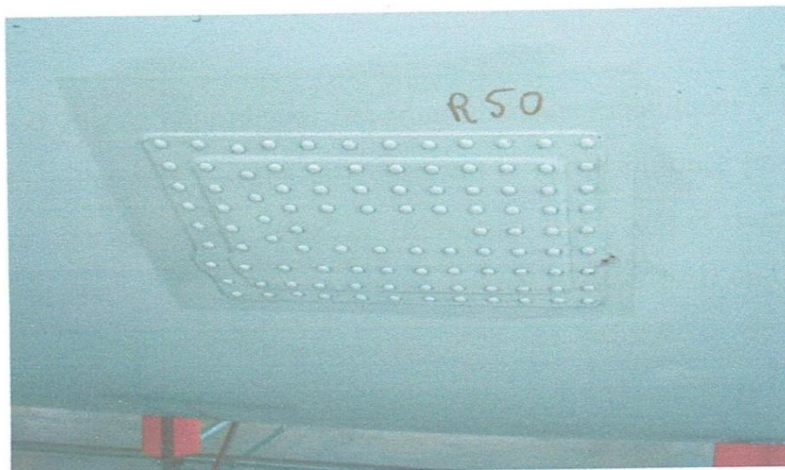
Figure I.2 : Réparation patch riveté sur fuselage de Boeing.
