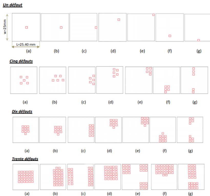
Figure I.47 : Représentation graphique de quelques nombres et positions des défauts dans la couche d'adhésif [43].
