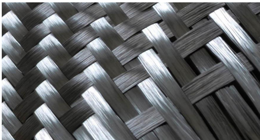
Figure I.4 : Une vue rapprochée sur du tissu en fibre de carbone [AYACHE Belqassim, 2019]
