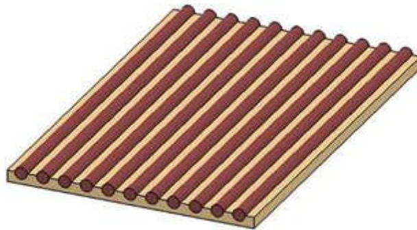
Figure I. 5 : Une monocouche à fibres longues UD
