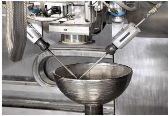
Figure I.11 : Fabrication additive par faisceau d'électrons avec dépôt à deux fils
