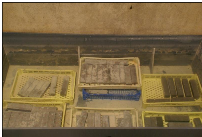
Figure III.3 : Le bac de conservation des échantillons dans l'eau à 20^{\circ}\text{C} \pm 2^{\circ}\text{C}
