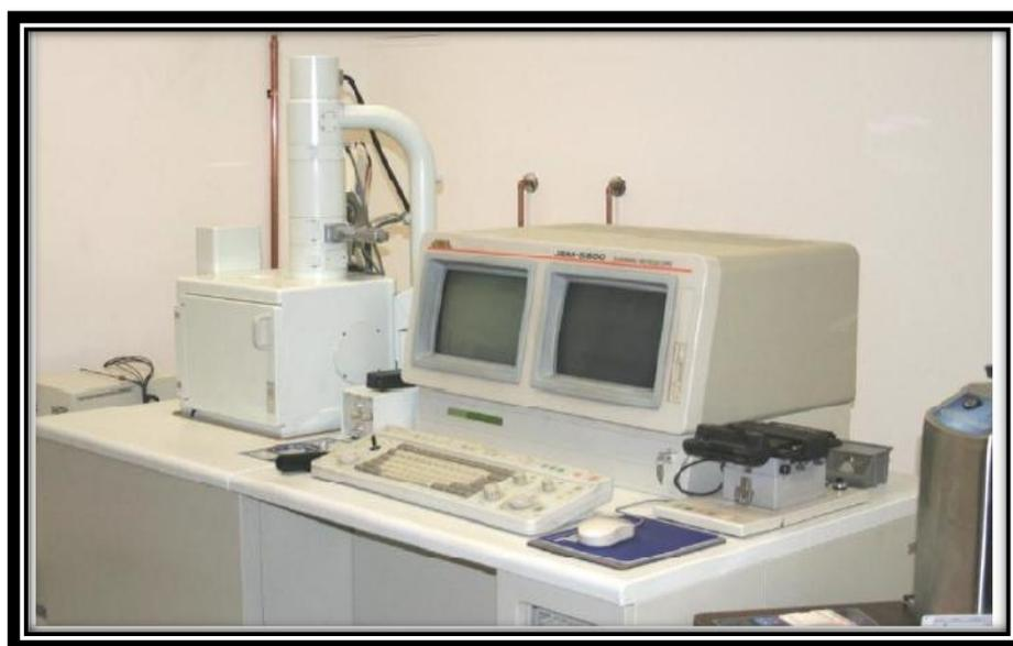
Figure.III.3. Microscope électronique à balayage M.E.B JOEL 5800 couplé avec EDS.
