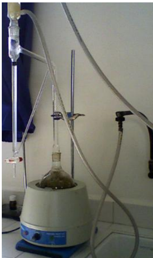
(Figure IV.2) : Montage d'extraction de type Clevenger (Laboratoire de Biodiversité Végétale)
