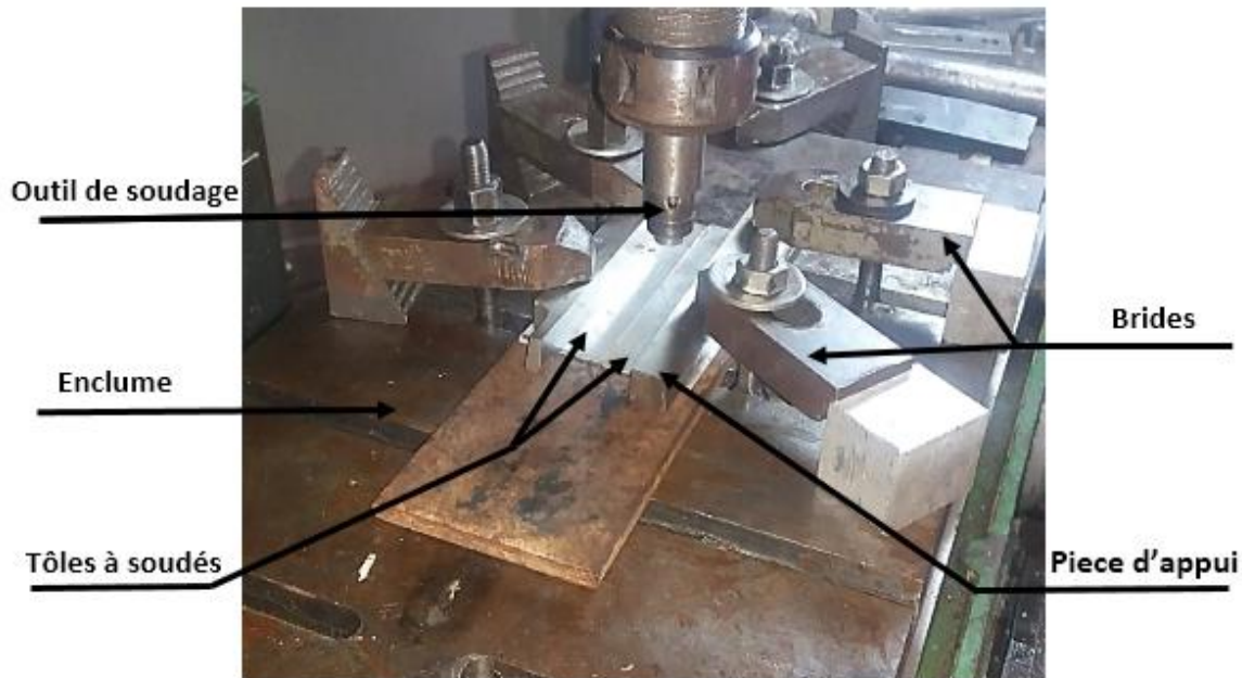
Figure II.13 :Système de bridage.
