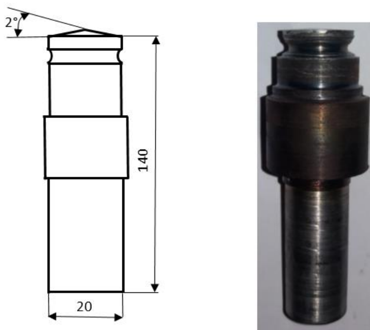
Figure II.12 : Outil de soudage par friction-malaxage sans pion.
