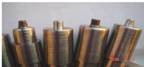
Figure I.10 : Configurations d'outils utilisés pour déterminer l'effet de la géométrie du pion sur la résistance en traction des joints FSW [37].
