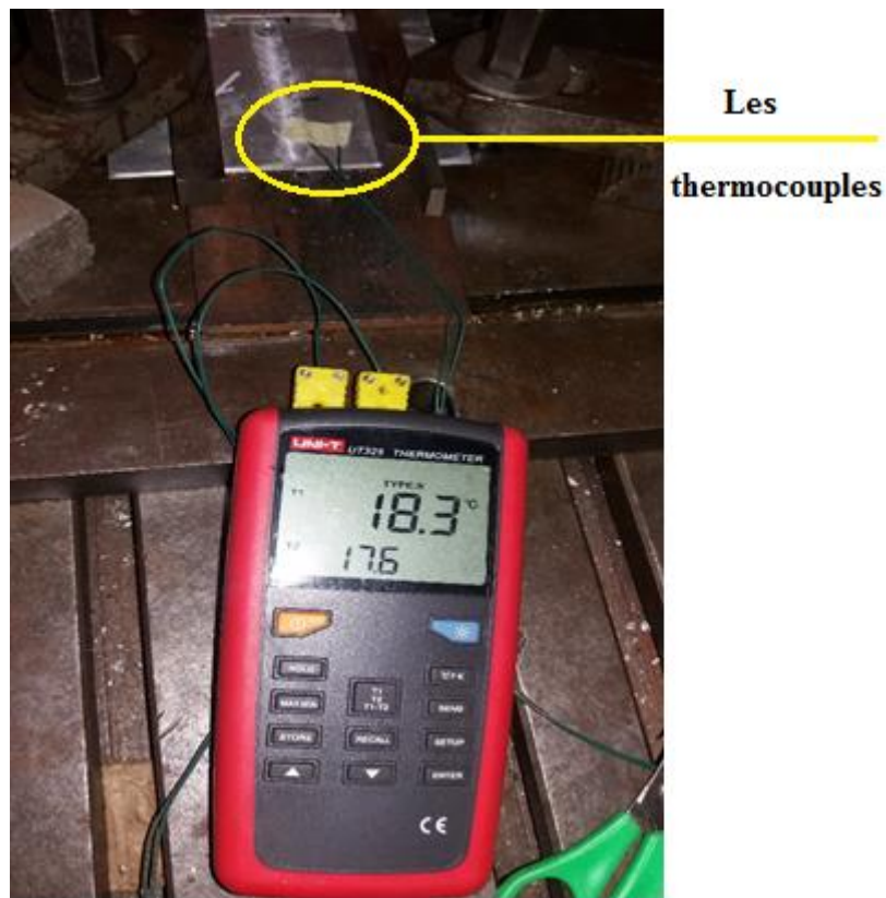
Figure II.14 : thermocouples sont installés sur les plaques.
