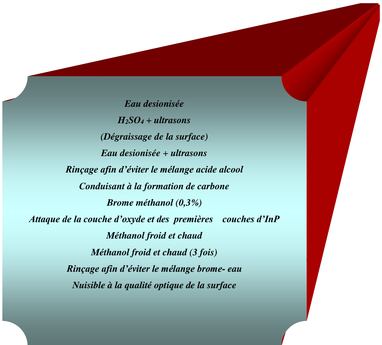
Figure [II-18]: Processus de nettoyage chimique de la surface d'InP (100)
