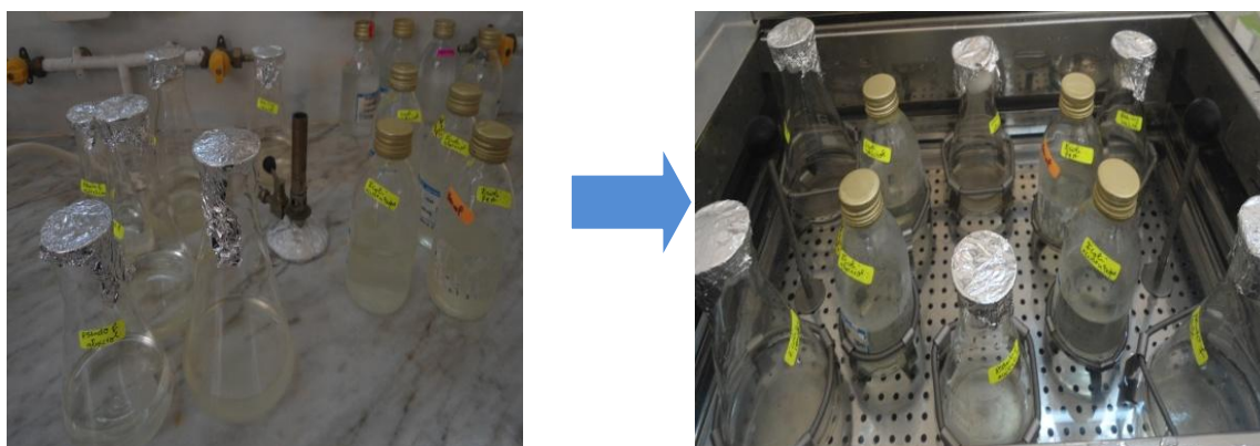
Figure IV.14 : Dispositif expérimental de la biodégradation en milieu liquide Les résultats sont donnés dans les tableaux (l'annexe 2).
