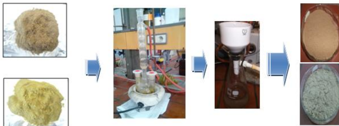
Figure II.3 : Montage expérimentale de traitement chimique des adsorbants
