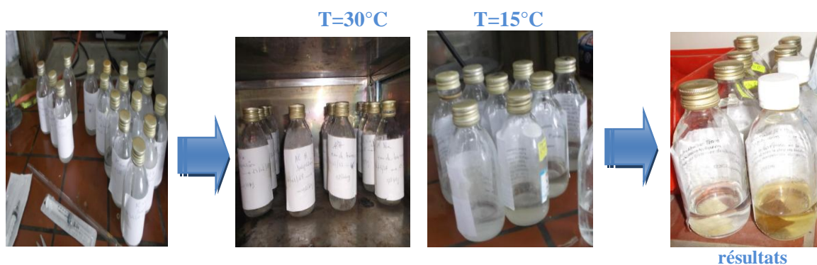
Figure IV.32 : Test d’immersion dans l’eau de mer naturelle
