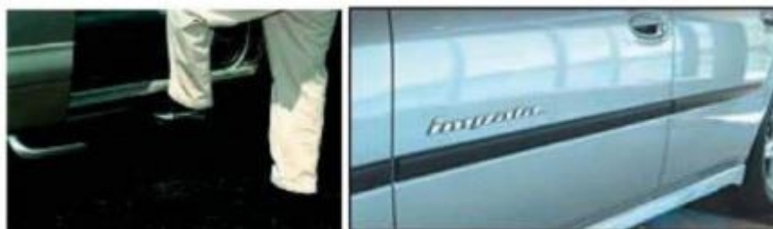
Figure 17 : Deux des premières applications commerciales de nanocomposites dans l’automobile : à gauche, les marches-pieds de mini vans Chevrolet et GMC et à droite, des baguettes de protection latérale [5].
