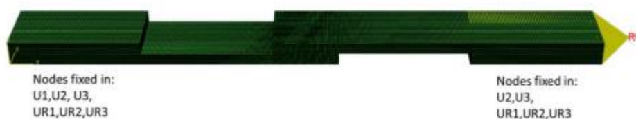
Figure 10 : Illustration des conditions aux limites et de chargement appliquées.
