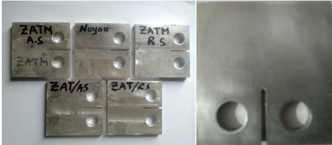
Figure IV.2 : Epreuve CT50 avant et après polissage.
