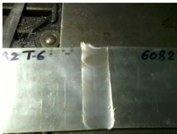
Figure III.10 : Tôles soudées en alliage d'aluminium 6082-T6.
