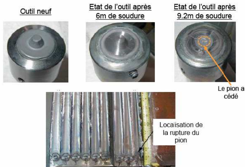
Figure I.12 : Usure d’un outil lors du soudage d’un acier [15].
