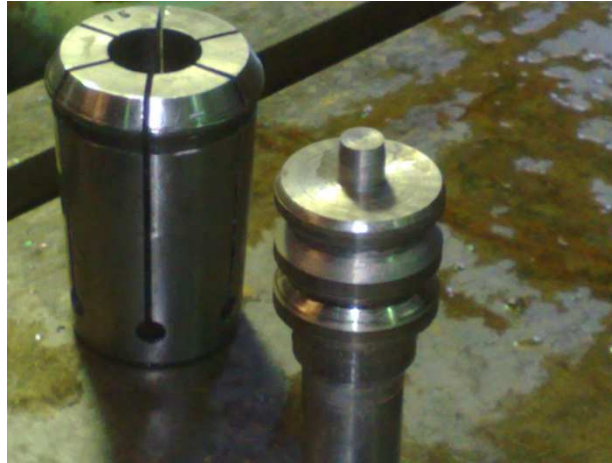
Figure III.7 : Mandrin et outil de soudage FSW
