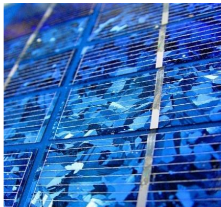
Fig.2.14. Panneau solaire en Silicium polycristallin.
