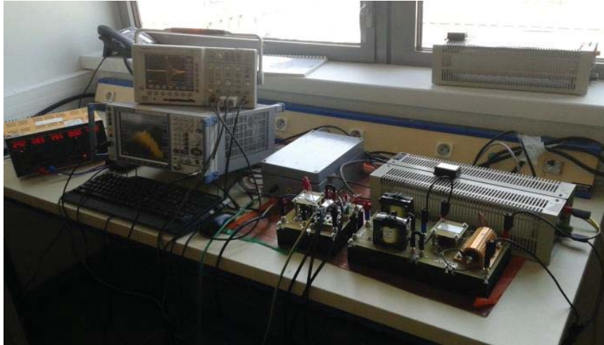
Figure III.6. Photographie du banc d'essai : Alimentation + RSIL + Hacheur "buck" + Charge ( L = 2 \times 500 \mu\text{H} , C = 8 \times 22 \mu\text{F} , R = 100 \Omega ) avec un oscilloscope électronique et un analyseur de spectre [46].
