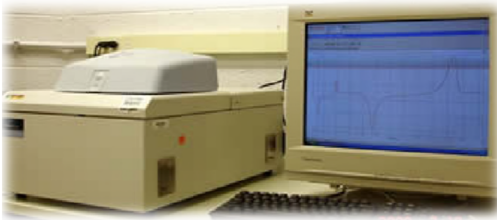
Figure IV.3: Pyris Diamond l'équipement utilisé pour l'essai DSC.
