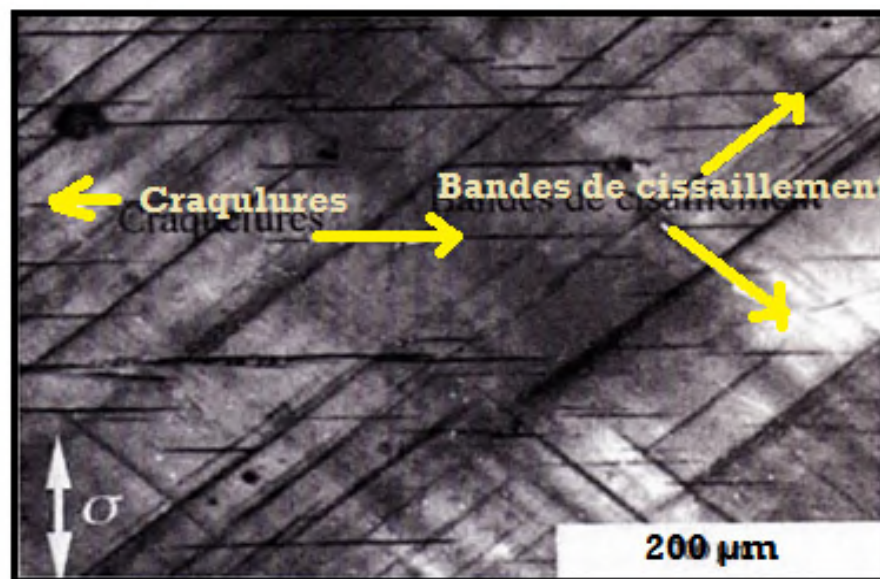
Figure I.15 : craquelures et bandes de cisaillement dans un polycarbonate sollicité en traction à température ambiante[34]
