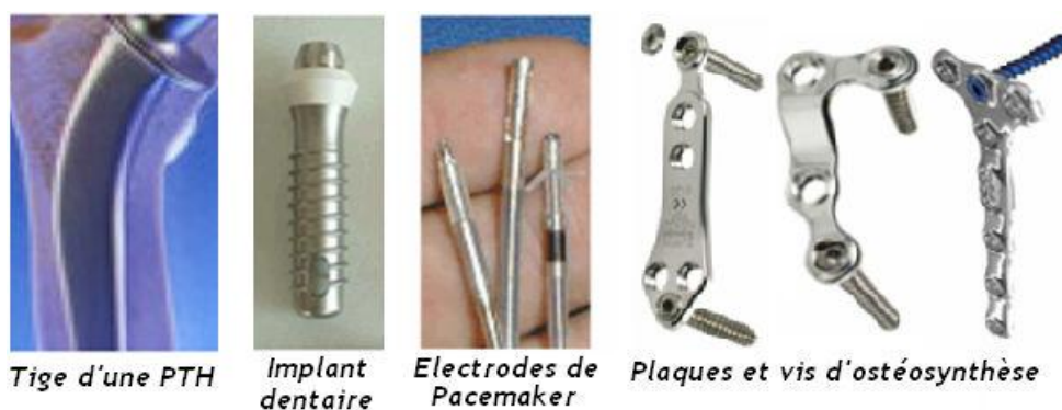
Figure 2. 4 : Tige d'une PTH, implant dentaire et électrodes de pacemaker en titane, plaques d'ostéosynthèse en Inox-316L, et vis en Ti-6Al-4V [20]
