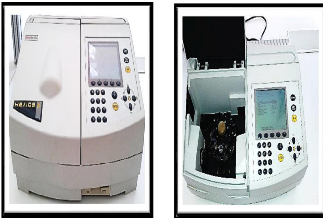
**Figure 27: Spectrophotomètre utilisé pour le dosage des composés phénoliques**
