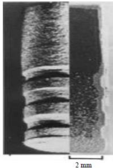
Fig II-3 : Implant dentaire en FGM (Ti/20HAP). Aspect externe (gauche) et section transversale (droite). (Watari 2004)
