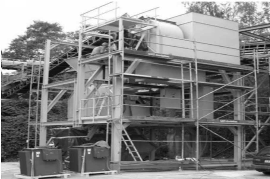
Fig.2.3 : Premier prototype industriel pour l'électroporation de betteraves à sucre [33]
