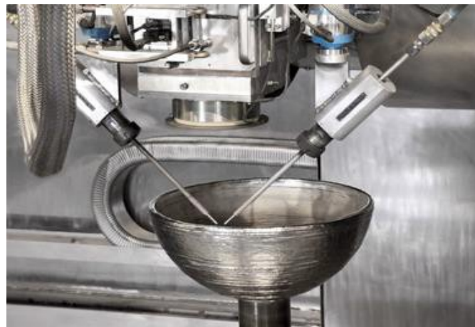
Figure I.8 : Fabrication additive par faisceau d'électrons par dépôt de double fil [98]
