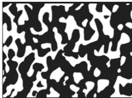
Figure I.5 : Matériau à deux phases avec microstructure du squelette
