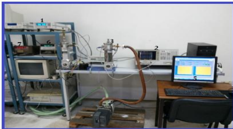
Figure IV.36 : Banc expérimental de spectroscopie d'impédance.
