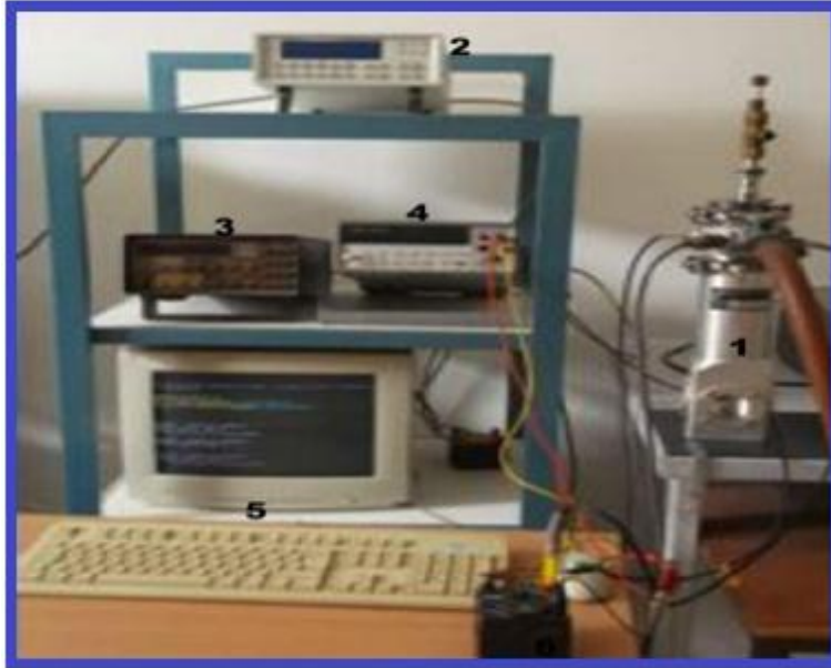
Figure IV.7: Photo du banc expérimental de mesure de la caractéristique (I-V).
