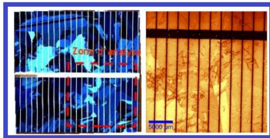
Figure I.5 : Photographie et image de photoluminescence d'une cellule photovoltaïque en silicium multicristallin. Les joints de grains et les dislocations apparaissent en foncé sur l'image de photoluminescence [3].
