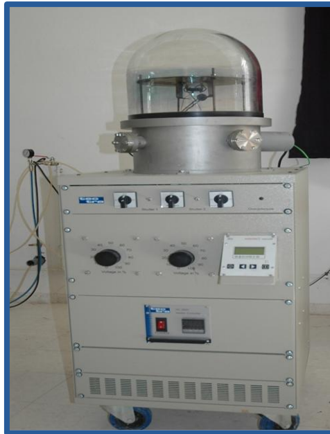
Figure IV.5 : Système de l'évaporateur sous vide.
