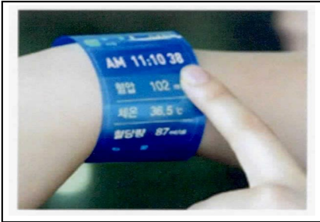
Figure I.15: Schéma montrant un bracelet à écran tactile et flexible réalisé à partir de graphène (Euloge.F. Guepi, 2011 ).
