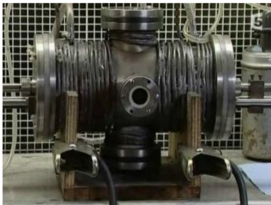
Fig. 1.10 : Photo et schémas de la méthode d'arc électrique.
