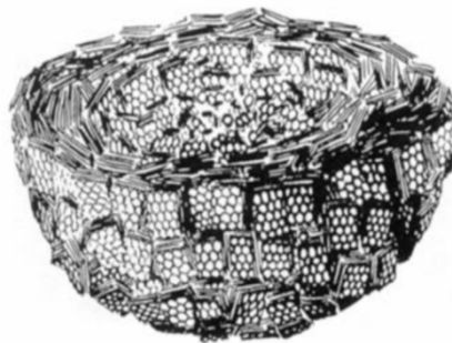
Fig. 1.2 : Vue en coupe d'une particule de noir de carbone [Hassar 2013].
