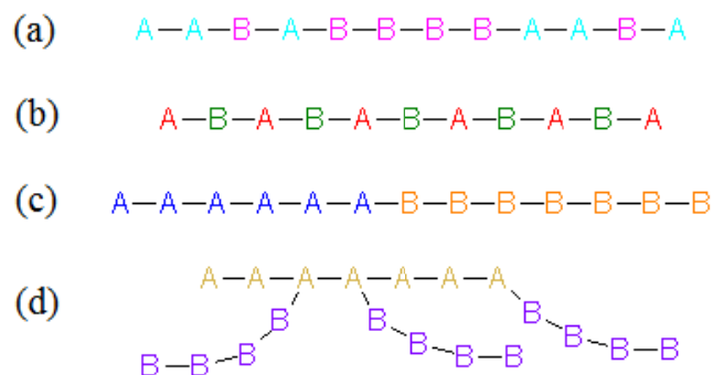
Fig. 2.3 : Copolymères, (a) statistique, (b) alterné, (c) séquencé, (d) greffé.
