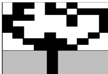
Figure II.32 : Antenne fractale ULB à fréquence rejetée utilisant l'algorithme génétique.
