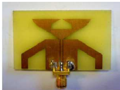
Figure II.43: Repliement volumique du plan de masse et de l'élément rayonnant [63] [ 64].
