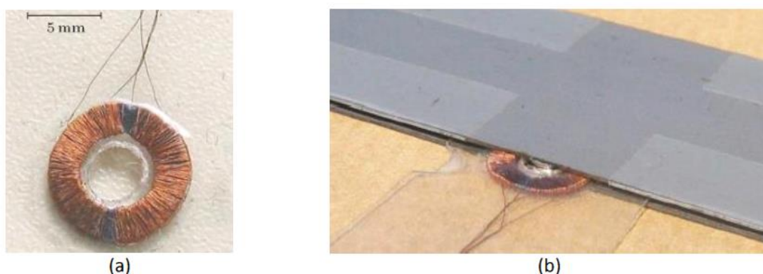
Figure.17 : (a) Vue de dessus d'une bobine de Rogowski (b) Application d'une bobine de Rogowski pour mesurer le courant de défaut intercalaire entre deux feuillets [3.18]
