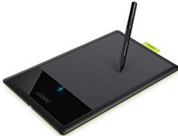
Figure V.2 : Tablette WACOM BAMBOO version 5.08-6 utilisée pour l'acquisition du signal d'écriture
