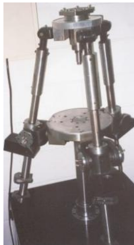
Figure 1.25 : le manipulateur 3-UPU à 3 ddls de translations
