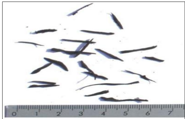
Figure 3.2 : Aspect de fibres de caoutchouc de pneus usés [BEK19].
