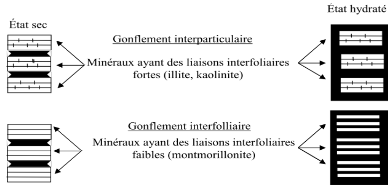
Figure 1. 8. Mécanismes de gonflement des argiles par hydratation [MOU88].
