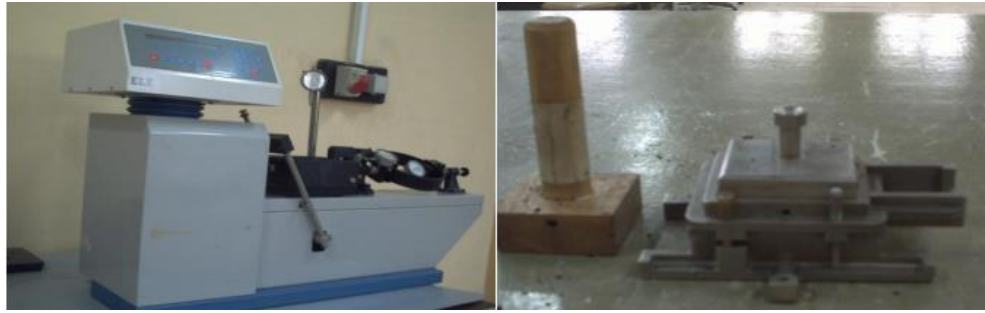
Figure 3.17. Photo de l'appareillage de l'essai de cisaillement.
