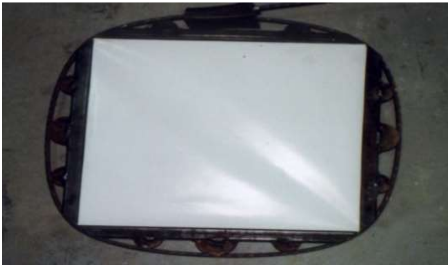
Figure I.15: Renforcement d'une colonne carrée par précontrainte additionnelle – coupe transversale (Saatcioglu et al. 2000)
