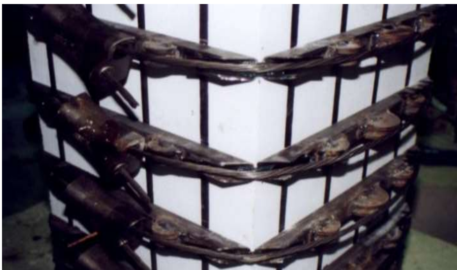
Figure I.16: Renforcement d'une colonne carrée par précontrainte additionnelle – coupe longitudinale (Saatcioglu et al. 2000)
