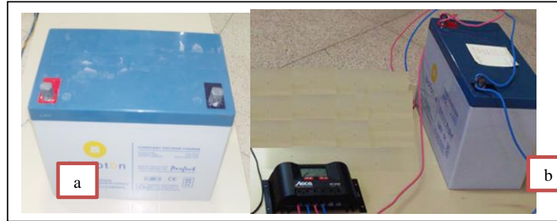
Figure 4.5. a) Batterie Isofoton 12V 80Ah b) Raccordement Batterie / Régulateur
