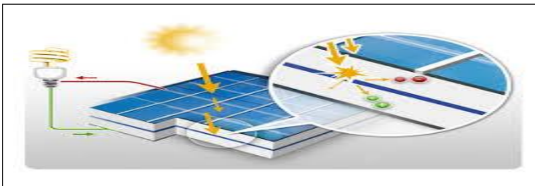
Figure 1.14. Principe de fonctionnement d'un GPV [50]
