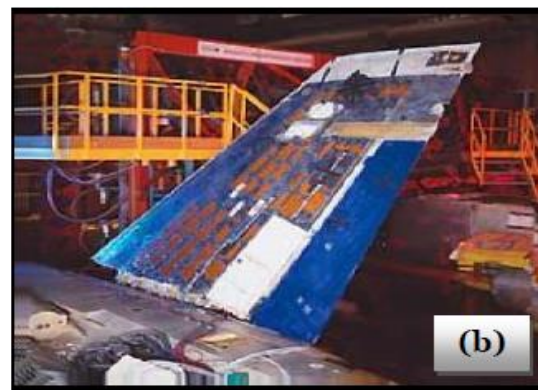
(b) vue générale d'une aile équipée de transducteurs piézoélectriques.
