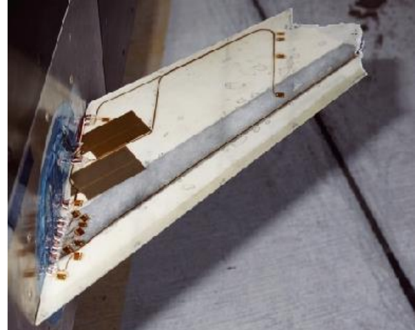
Figure (I.5.b) : Aile après défaillance équipée de deux actionneurs.
