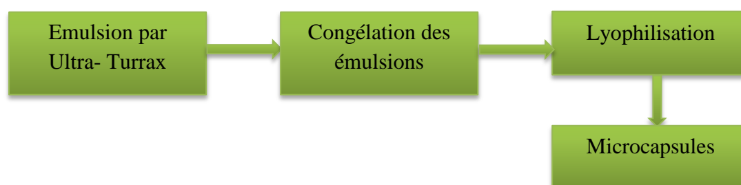
Figure III.2.3. Schéma de préparation des microcapsules chargées de l'HE de thuya de Berbérie
