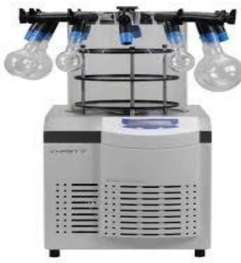
Figure III.2.2. Image d'un lyophilisateur
