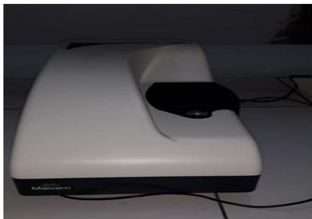
Figure III.2.4. Photo de Zétamètre employé
