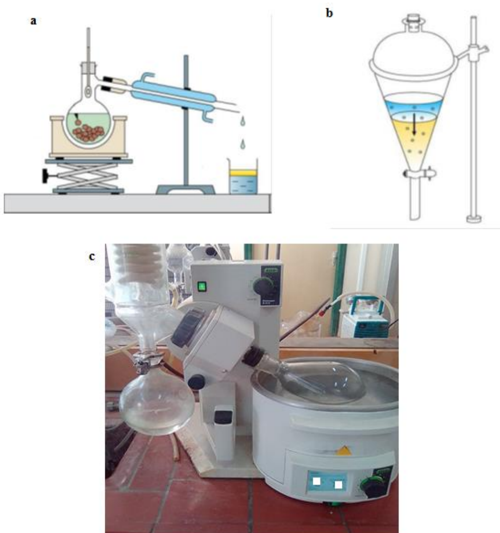
Figure III.1.2. Les étapes d'extraction de l'huile essentielle : a) l'hydrodistillation b) Séparation de l'huile essentielle c) Evaporation de solvant et récupération d'HE
