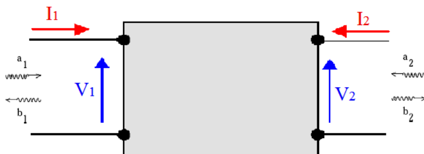
Figure 1-12 Présentation d'un quadripôle avec les ondes incidentes et réfléchies.
