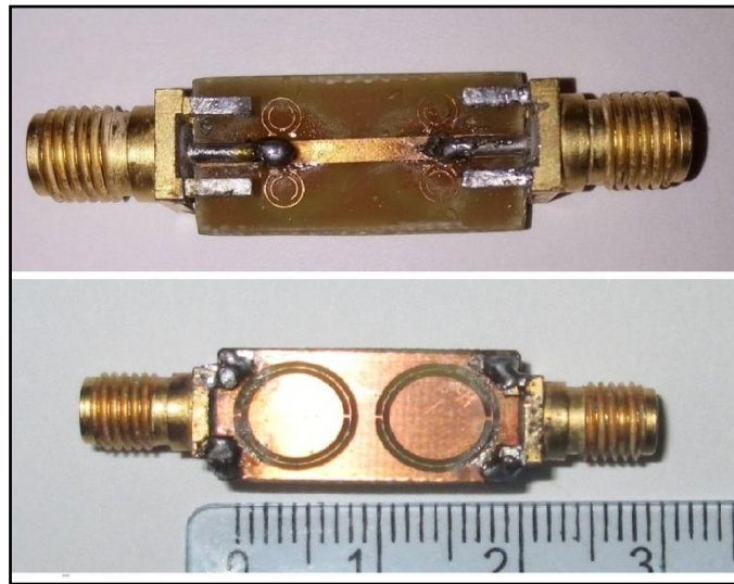
Figure 3-15 Photo du filtre coupe-bande fabriqué (a) couche supérieure, (b) couche inférieure.
