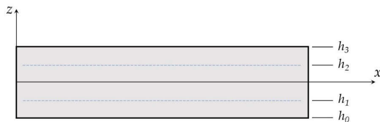
Figure I.7. Configuration de la plaque sandwich à gradient de propriétés (FGM).
