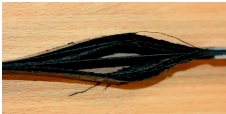
Fig. III.19 : Illustration du délaminage lors de l'essai de traction en raison des différences de raideur des plis [18].
