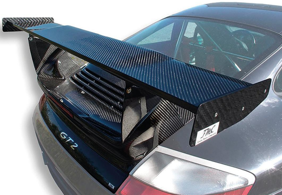
Fig. I.9 : Aileron en carbone préimprégné [6]
