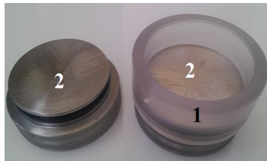
Figure 2.10. Chambre de traitement statique.1. Isolant en polycarbonate, 2. Électrodes.
