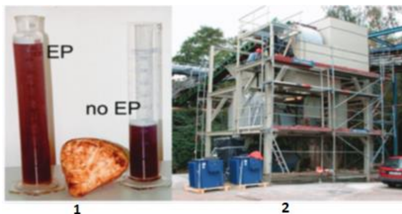
Figure 1.19. 1: Comparaison entre l'extraction du jus de betteraves par CEP et par la technique d'extraction traditionnelle. 2: l'installation industrielle utilisée pour le traitement des betteraves par CEP [79].
