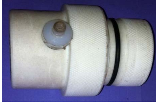
Figure 3.10 : Photographie de bouchon de centrage en téflon assurant une distance inter-électrode homogène.
