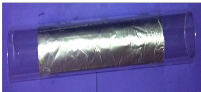
Figure 3.9 : Photographie d'une électrode métallique interne en adhésif d'aluminium à l'intérieur de la barrière diélectrique en verre.
