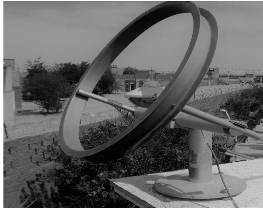
Fig. III. 1: Pyranomètre pour mesurer les données de irradiations diffuses sur le site de la cellule de test.
