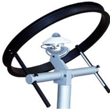
Fig. II. 2: l'instrument qui meure le rayonnement diffus.
