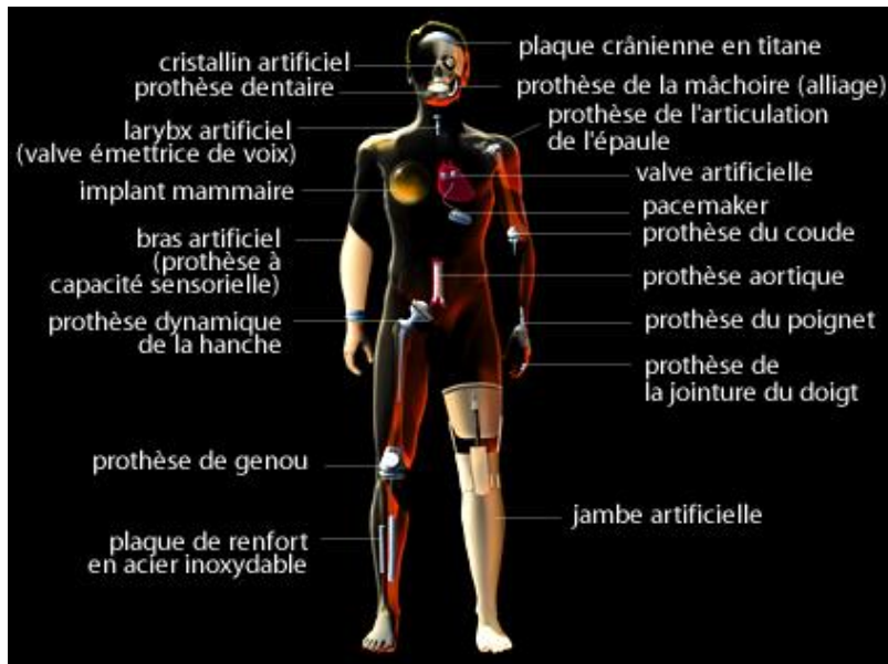
Figure.II. 4 : les organes peuvent être remplacés par des biomatériaux [46]
