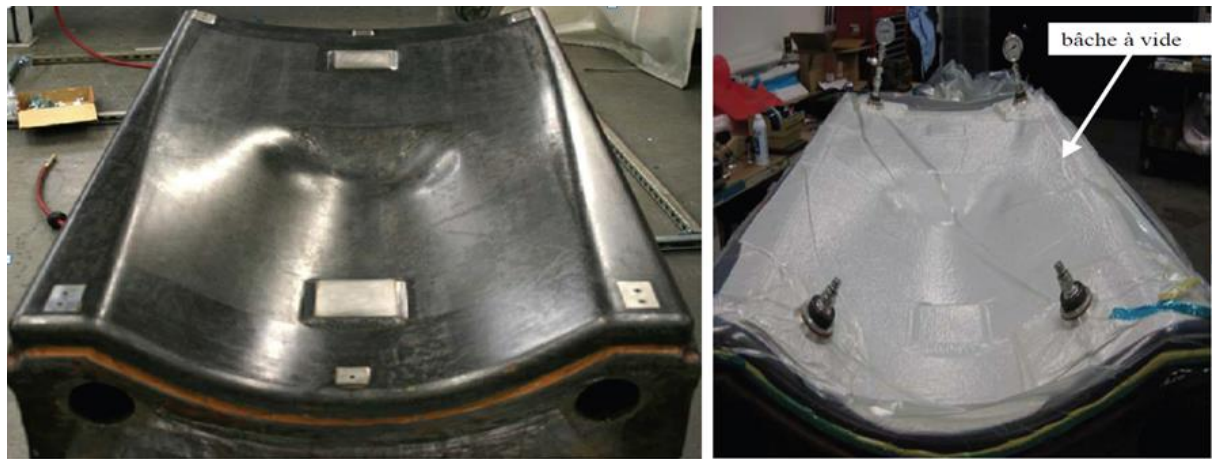
Fig II.4 moule en Hextool™ pour RTM-light (société NovaTech) [3]
