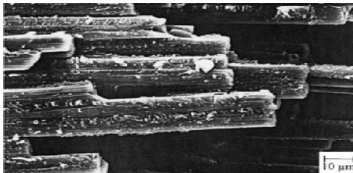
FigIV.9 Observation par fractographie de la rupture de fibres dans un stratifié en carbone-époxy [9.IV]
