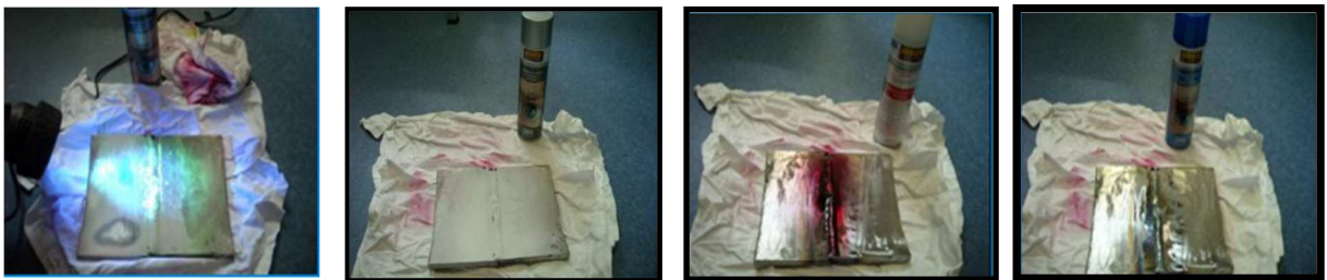
Figure 22. Les étapes du contrôle par ressuage.
