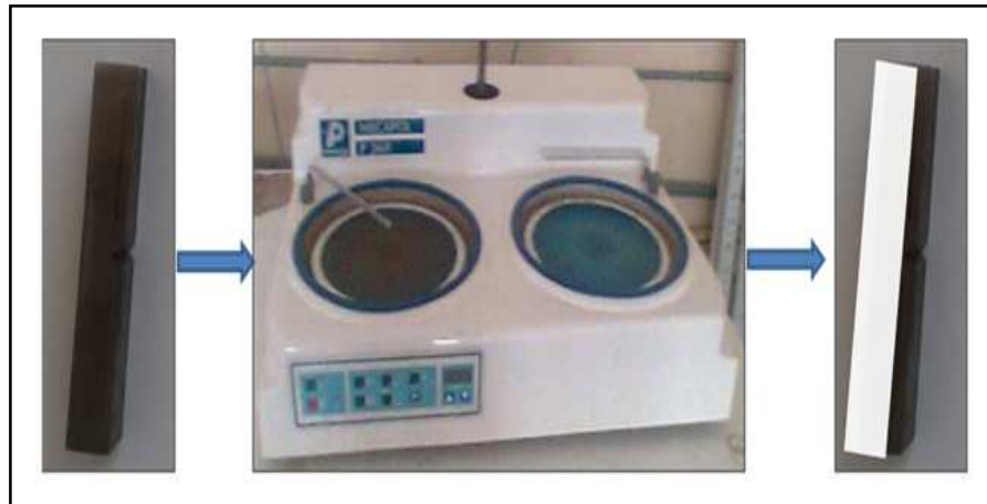
Figure 34. Schématisation de polissage des éprouvettes de l'acier A510AP.
