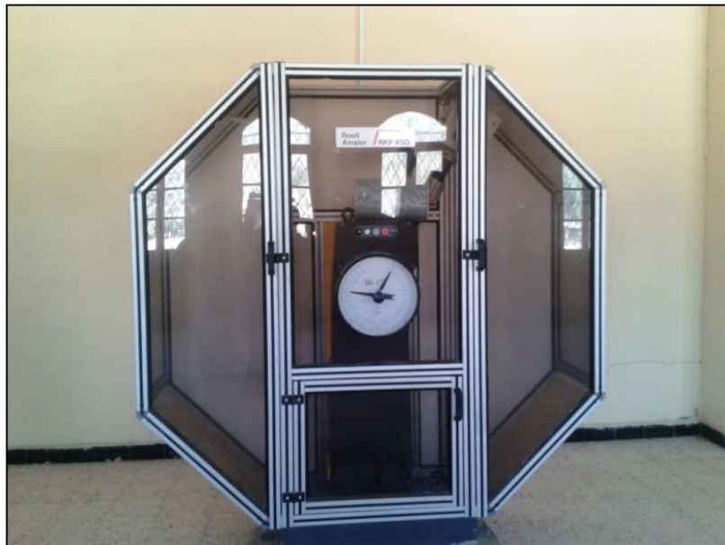
Figure 31. Machine RKP 450 Moutons pendule à 450 joules.
