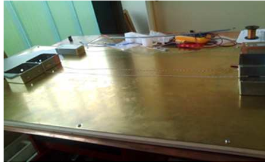
Figure III.26. Photographie du montage expérimental effectué entre un fil simple coupable et un câble torsadé non blindé victime pour deux espacements différents ( d = 6 \text{ cm} , d = 12 \text{ cm} ).
