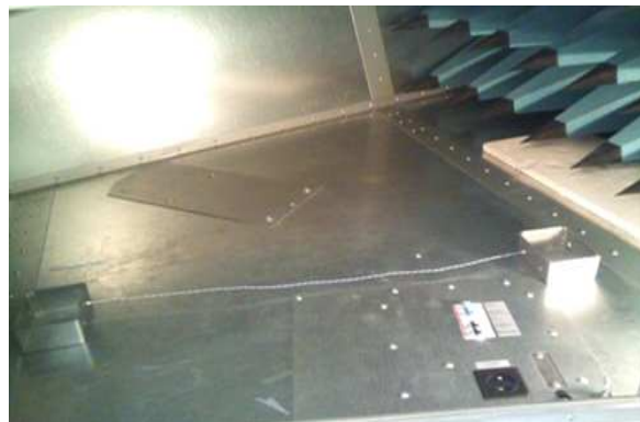
Figure III.12. Photographie de l'expérience d'un fil conducteur simple à l'intérieur de la cellule GTEM au niveau de la zone de test.
