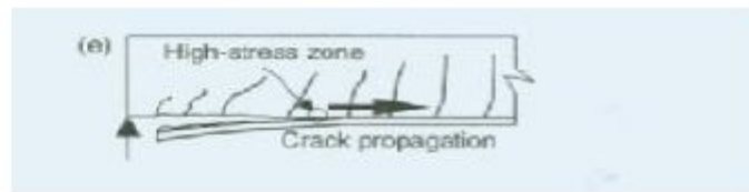
e) Décollement de l'interface des extrémités de la plaque
