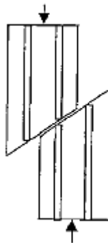
Figure III.2 Mode de rupture en compression par cisaillement
