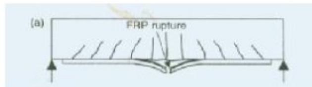
a) Défaillance flexionnelle par rupture de PRF
