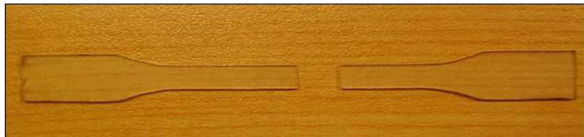
**Figure II.2 :** Epreuve d'époxy fabriqué au laboratoire.
