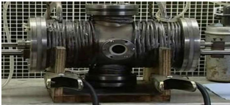
Figure I.10 : Schéma d'un réacteur de synthèse de nanotubes monocouches par arc électrique [12].
