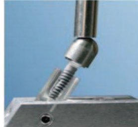
Figure. 1.12. Essai de fatigue sous un angle latéral de 30^\circ [5]
