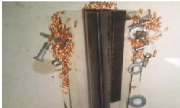
Figure III.28 : Reste de récupération avec tension de 10v
