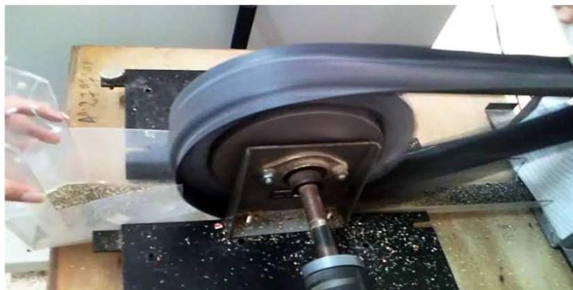
Figure V-16 : Séparateur à deux collecteurs
