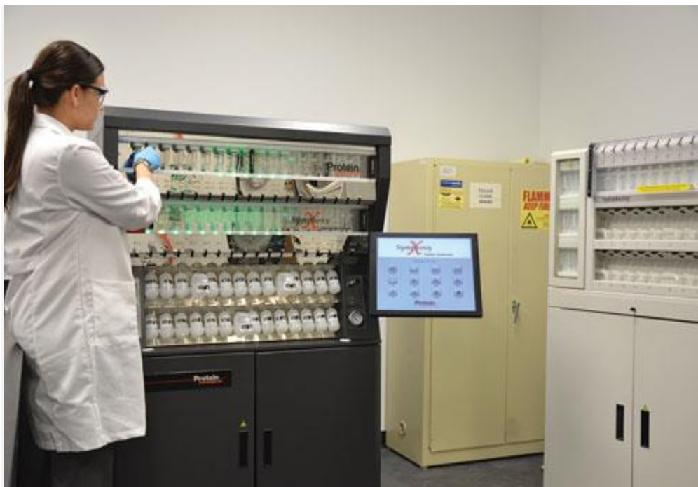
Figure 3.7. La technologie de synthétiseur automatisé de protéines conçue spécifiquement pour la synthèse multiple de peptides en phase solide. ( Genetic Engineering and Biotechnology News )
